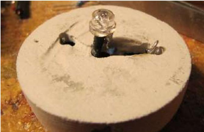
*Abbildung 6: Alles eingebaut - LED, Widerstand, Schalter und Knopfzellenhalterung*
