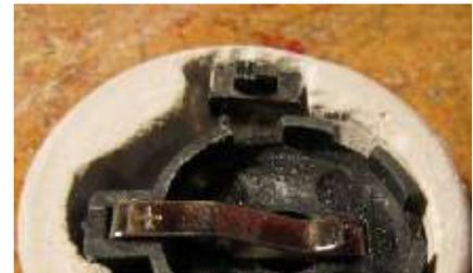
Abbildung 5: Mikro-Schiebeschalter
